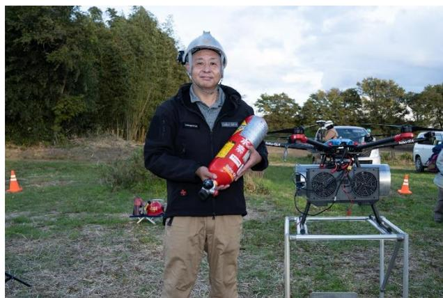
左：日本初の飛行をした水素燃料電池ドローン 右：ドローンに搭載している特別仕様の高圧水素用複合容器（ロボデックス 代表：貝應大介）
